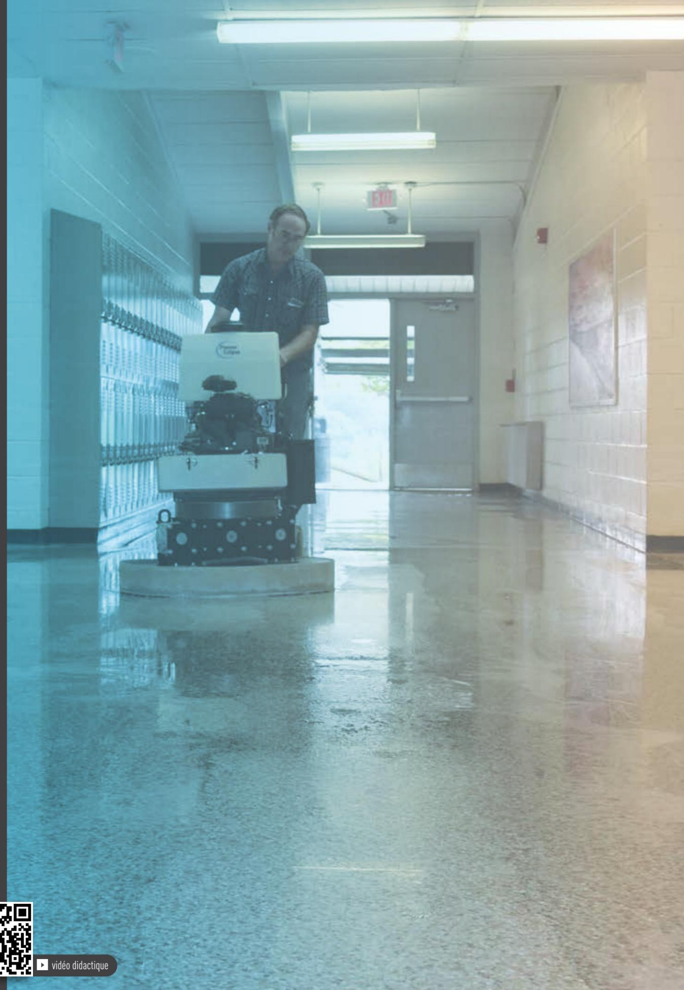
La gamme de machines de meulage et de polissage de Pioneer Eclipse offre des solutions pour une large gamme de procédures de réparation et de maintenance. Toutes ces machines électriques ou au propane sont équipées de série de réservoirs de solution embarqués et acceptent plusieurs plaques de moteur de disque diamant et de patin.
